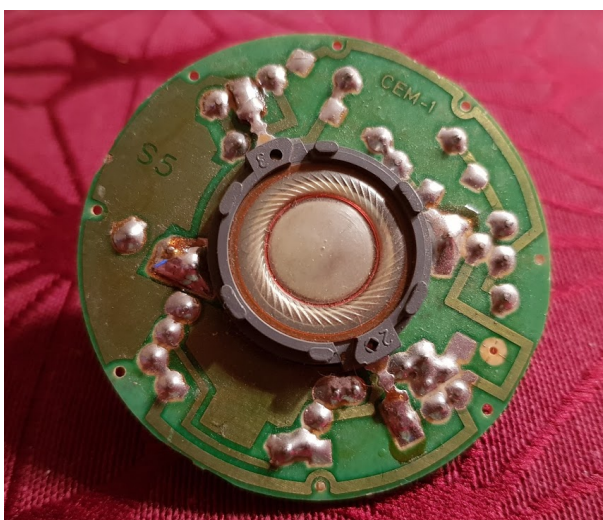
Abbildung 4: AKG Transistorkapsel geöffnet
